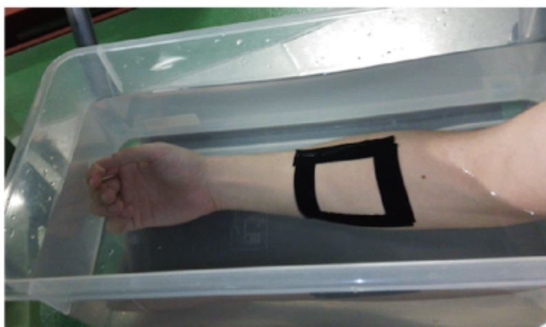
図 6-3. 水分量変化させるために前腕内側部を水に浸している時の様子
