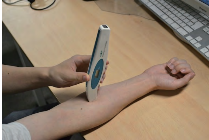
図 6-1. 表皮水分計 (Skin Moisture Sensor MY-808S, Scalar Corporation)
