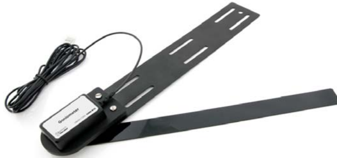
Rajah 3: Goniometer- pengesanan sudut sendi dipasangkan kepada lengan statik logam
