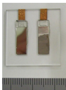
Fig.7.3.1 平面乾式pHセンサ
