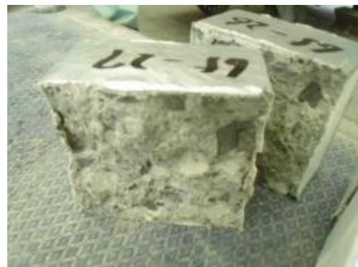
写真 5.2.12 割裂した試験体
