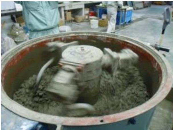
写真 5.2.1 コンクリートの混練
