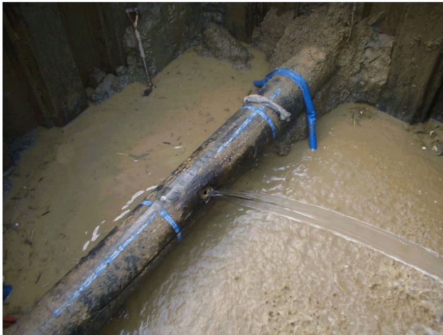
図 10 土壌埋設水道管における腐食状況
