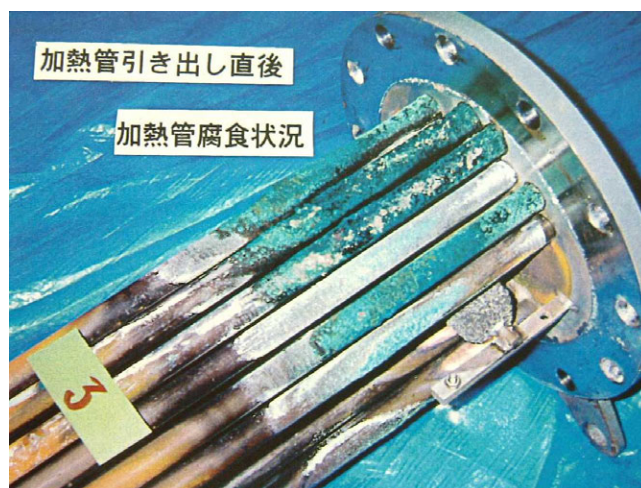
(c) 過熱管の腐食状況
