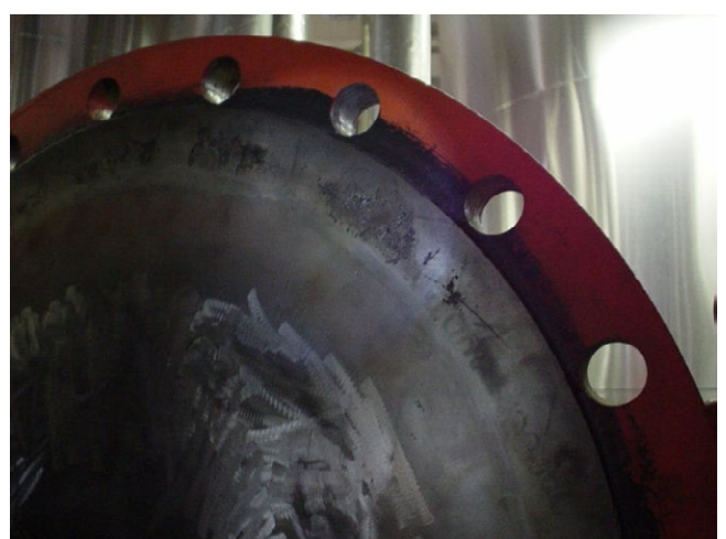
(b) 蓋と本体の合せ面のすきま腐食
