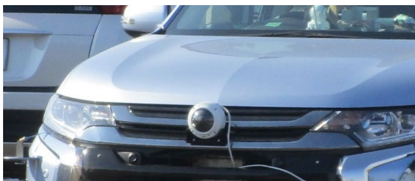
図 4-2 広角の車載カメラ
