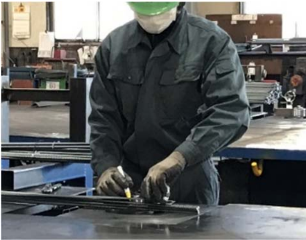
図 3-11 鉄筋材料に加工寸法を転記
