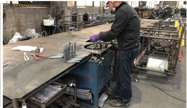
図 3-14 3次元的な曲げ加工
