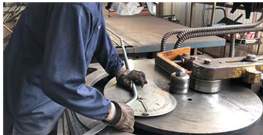
図 5-17 曲げ加工の検査状況
