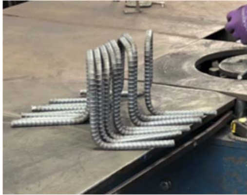
図 5-6 3次元方向の曲げ加工形状例
