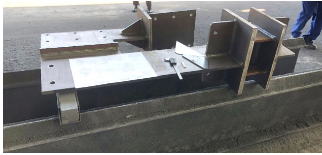
写真 3-4 題材とした鉄骨仕口部材
