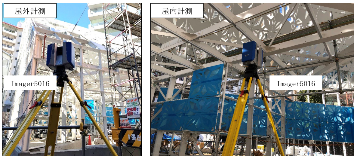
写真 4-5 工事現場内の3次元スキャン
