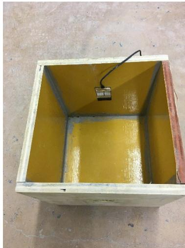
写真-5.9 パッチ型センサの試験容器への設置状況
