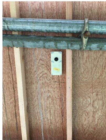
写真-7.5 点電極センサの設置状況
