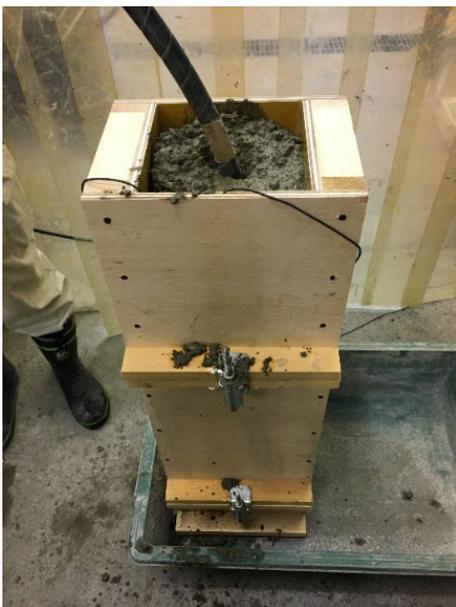
写真-5.6 振動試験状況
