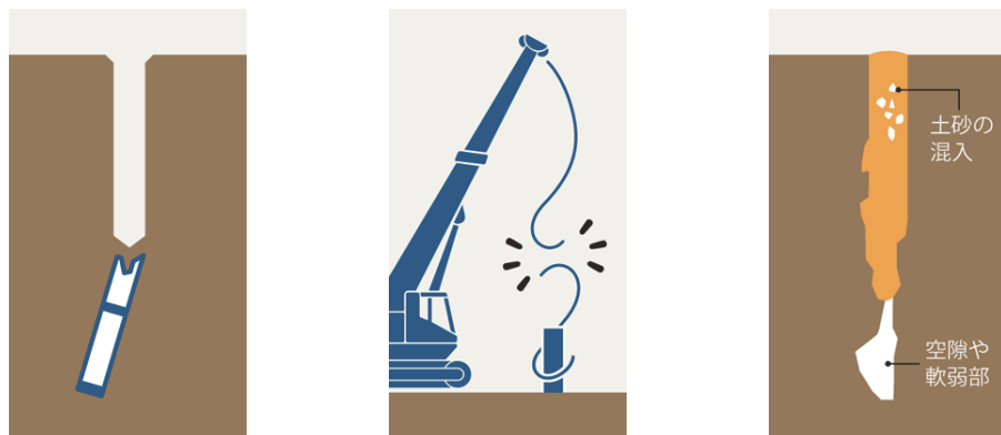
(a) 杭の地中残置 (b) ワイヤーの破断 (c) 不均一な充填
