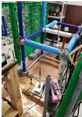
アーク放電試験回路外観
