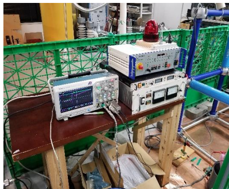
アーク放電試験電源装置及び測定装置
