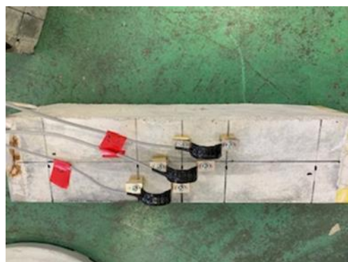
写真 3－4 \pi 型ゲージ設置状況
