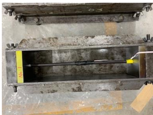
写真 3－3 拘束鉄筋および型枠
