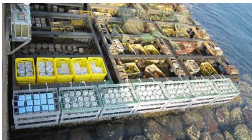
図 2-5 干満帯に暴露したコンクリート供試体
