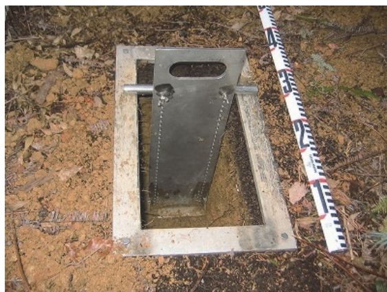
図-2.11 スクレーパープレートによる土壌試料採取の様子
