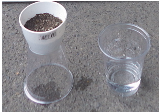
図-5.5 排水性能試験の様子
