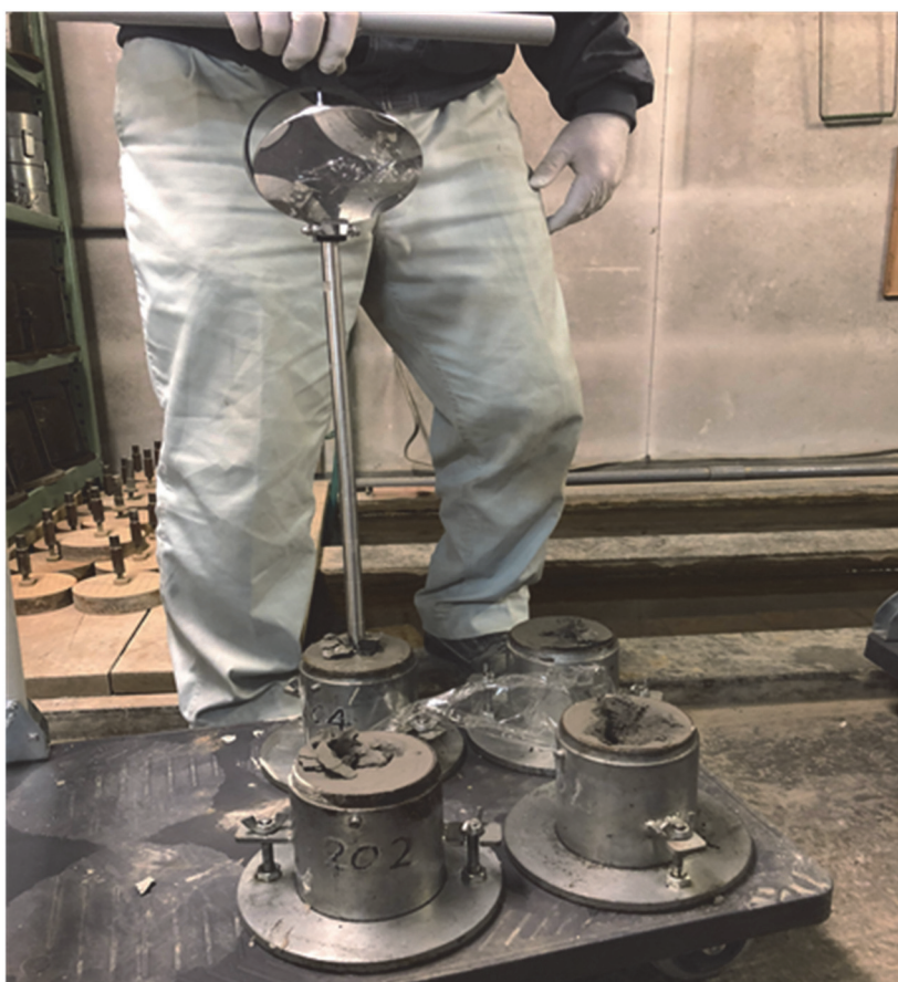
図-3.23 コーン指数試験の実施様子
