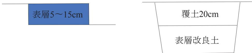
図-3.8 集積反転工法の施工イメージ
