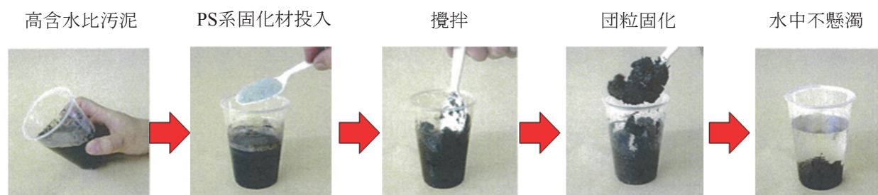
図-3.12 PS 系中性固化材の混合・攪拌
