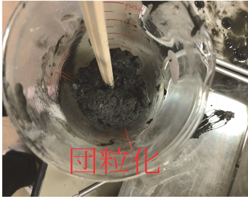
図-3.25 PS系中性固化材の団粒化の様子
