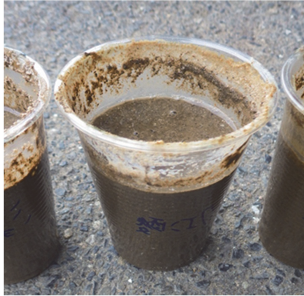
図-5.2 pH試験ならびにEC試験の概要
