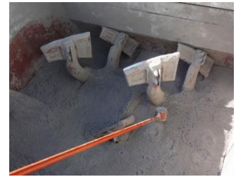
写真 3-5-7 大型ミキサー内の試料採取状況
