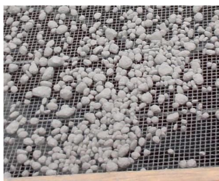
写真 3-5-8 試験 No.3 の終了後に 5mm 篩に残留したダマの状況 58)
