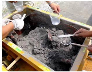
写真 3-5-6 小型ミキサー内の試料採取状況
