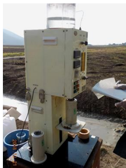
写真 3-4-3 現場での塩酸反応熱法の試験状況
