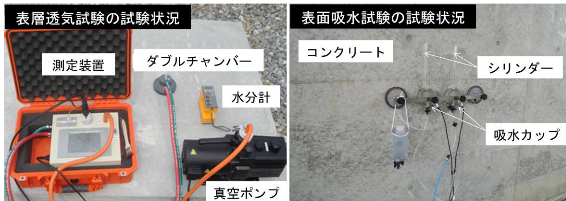
写真-1.1 表層透気試験および表面吸水試験の試験状況
