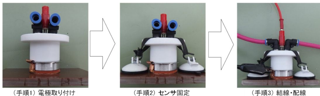
図 4-26 平面用測定センサの取り付け状況
