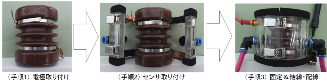
図 4-28 円筒面用測定センサの取り付け状況
