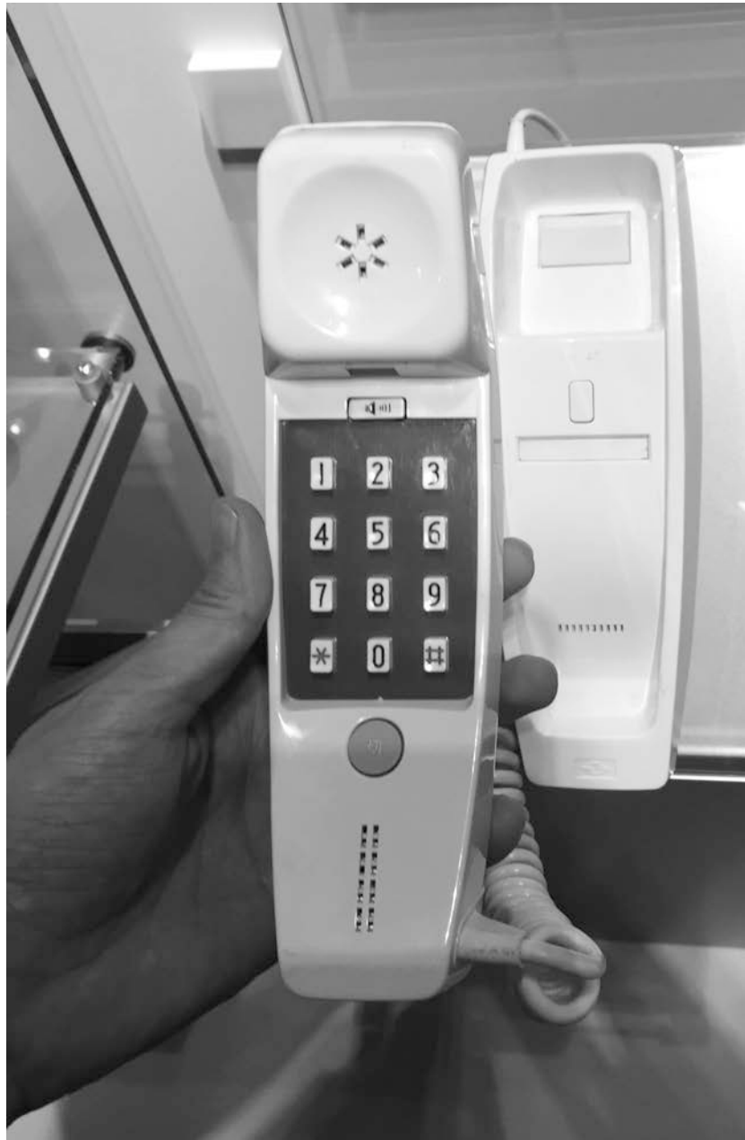
資料 2-1 700P 形電話機（ミニプッシュホン）の操作キー部、ハンドセット内側（レシーバーとマイクの間）に配置
