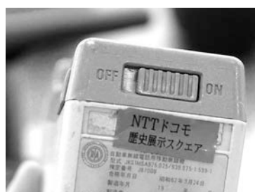
図 2-3 底面に配置された電源キー
