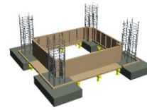
<施工手順09：基礎梁・支保工>
