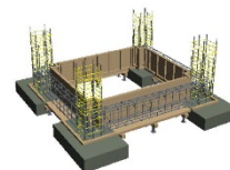
<施工手順17：基礎柱・帯筋展開>
