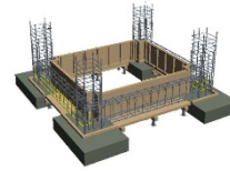
<施工手順15：基礎梁・下端主筋(短辺)>
