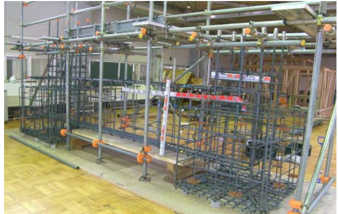
写真1 卒業研究の鉄筋配筋状況（下部構造）
