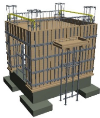
<施工手順49：2階梁・上端主筋(短辺)>
