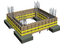
<施工手順21：基礎梁・横端太>
