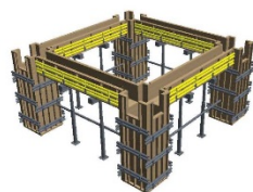
<施工手順⑥ 上側セパレータ・単管>
