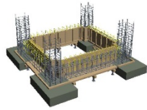
<施工手順18：基礎梁・スラブ差筋>
