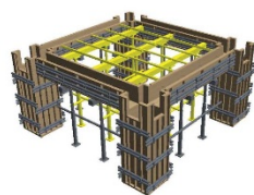
<施工手順⑦ スラブ支保工・大引き・根太>
