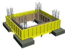
<施工手順19：基礎梁・型枠>
