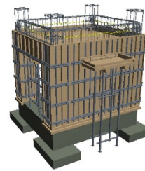
<施工手順52：2階梁・腹筋、幅止筋>
