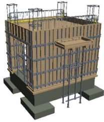
<施工手順48：2階梁・下端主筋(長辺)>
