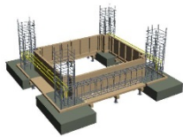
<施工手順13：基礎梁・上端主筋(短辺)>
