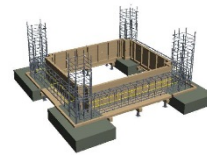
<施工手順16：基礎梁・腹筋、幅止筋>
