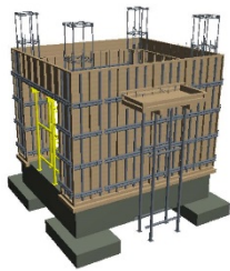
<施工手順43：2階梁・支保工>
