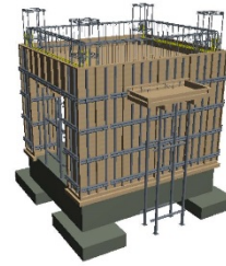
<施工手順51：2階梁・下端主筋(短辺)>
