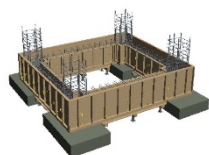
<施工手順20：基礎梁・セパレーター>
