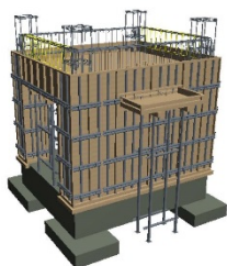
<施工手順50：2階梁・あばら筋(短辺)>
