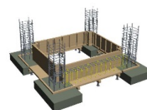
<施工手順11：基礎梁・あばら筋(長辺)>
