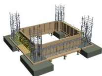
<施工手順14：基礎梁・あばら筋(短辺)>
