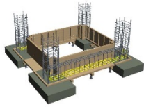
<施工手順12：基礎梁・下端主筋(長辺)>
